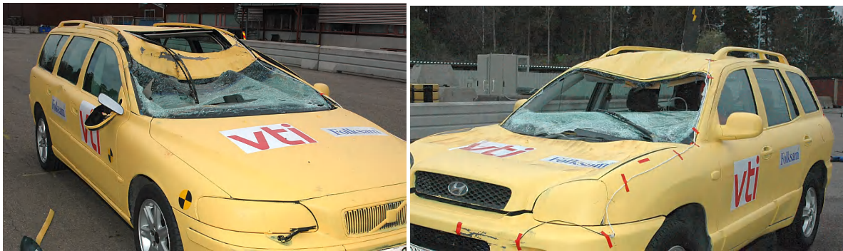
Figur 17. Volvo V70 med taklucka och Hyundai Santa Fe efter krock.
