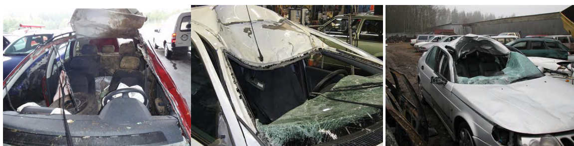
Figur 10-12. Olika takdeformationer från vänster takrivning, takinträngning och inträngning av älg i kupén.
