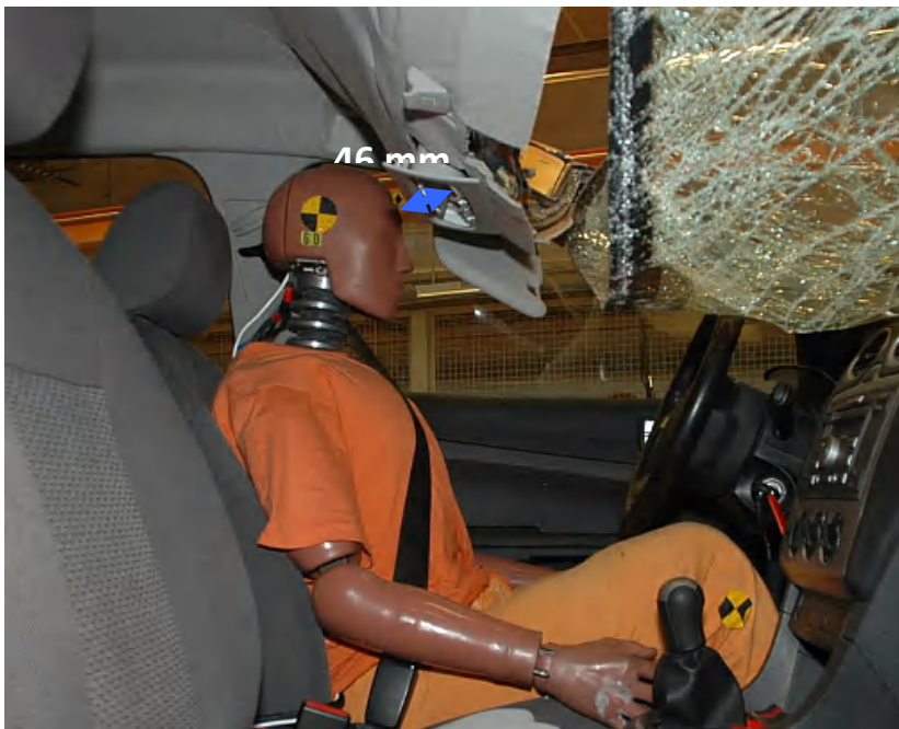
Figur 15. Exempel på takinträngning i Ford Focus.
