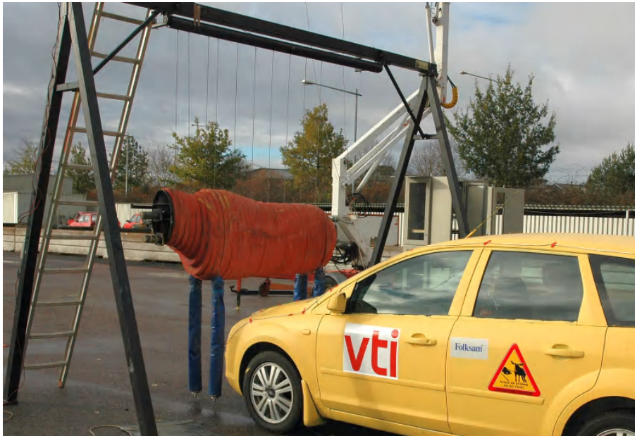
Figur 5. Provpuppställning älgatrapp hängande i ställinor som släpps vid kollisionen.
