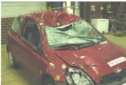
Figur 3-4. Älgkollision där bilen varit utrustad med krockpulsmätare (Folksams svarta låda), hastighetsändring 9 km/h och medelacceleration 3,3 g. Föraren fick lindriga skador.
