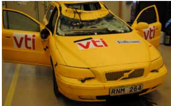
Volvo V70 efter en kollision i 90km/h med älgattrappen Mooses II rakt framifrån.
